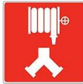
Raccord-pompier alimentant les canalisations incendie (colonne montante)
