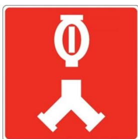
Raccord-pompier alimentant le système de gicleurs
